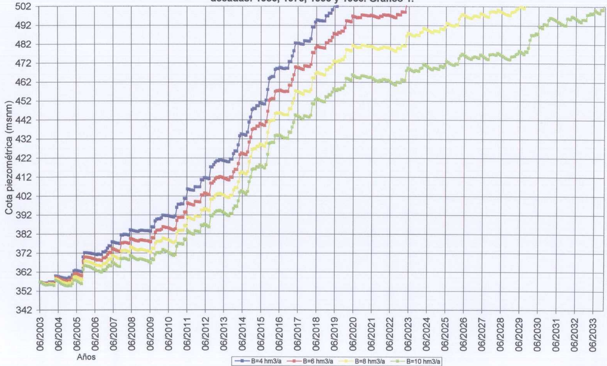
Figura 24. Evolución de los niveles piezométricos en el acuífero de Solana ante diferentes alternativas de explotación del acuífero. Secuencia climática definida según la climatología acaecida en las siguientes décadas: 1980, 1970, 1990 y 1960. Gráfico 1.
