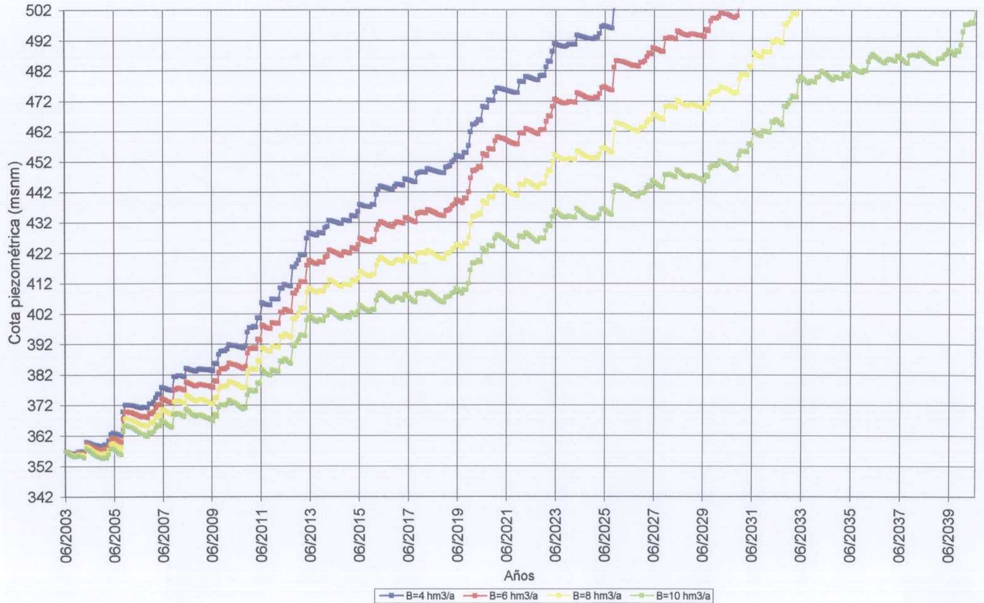
Figura 20. Evolución de los niveles piezométricos en el acuífero de Solana ante diferentes alternativas de explotación del acuífero. Período climático 1980-1999. Gráfico 1.
